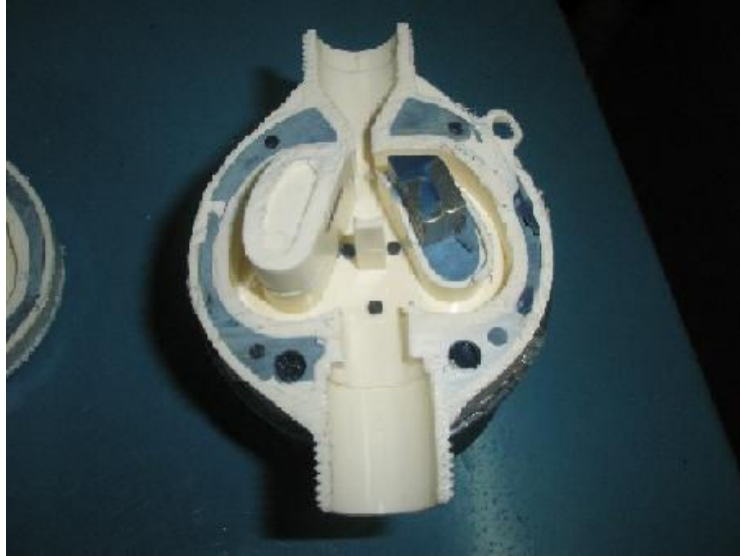
Plat B1: Keratan rentas meter air SmartMeter SM 150E
