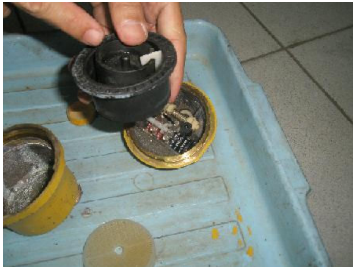
Plat B2: Keratan rentas meter air Mechanical Meter TD 88
